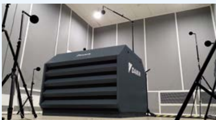
Pomiar poziomu mocy akustycznej w komorze akustycznej
